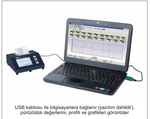
pürüzlülük test cihazının bilgisayarlar tarafından çalıştırılması
