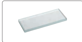
50mm okuma skalası (büyütme hassasiyeti kontrol edilir)
