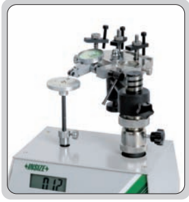
salgı satlarının ölçüm kuvveti kontrol uygulaması
