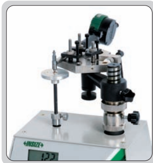
silindirik komparatörlerinin kuvvetini ölçün
