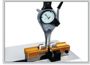
iç ve dış kalınlık komparatörleri için kalibrasyon
