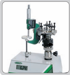
mikrometrenin ölçüm gücünü kontrol edin
