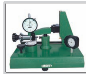
yanal kuvvetin komparatör saatinin doğruluğu üzerindeki etkisini test etme (yarım yuvarlak blok master gereklidir)
