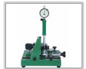
silindir komparatörün doğruluğunu kontrol etme (aralık 6-450mm)
