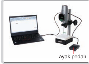
ayak pedalı veri, yazılım olmadan Excele aktarılır, veri aktarımı için ayak pedalına kısa basılır, sıfırlama için uzun basılır
