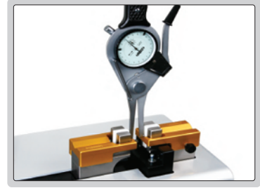
mandallı iç ve dış komparatörlerin sıfırlanması ve kalibrasyonu
