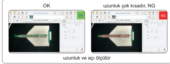
kesici aletlerin ölçümü
