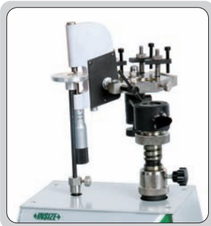
çeşitli mikrometre kafalarının ölçüm gücünü kontrol edin
