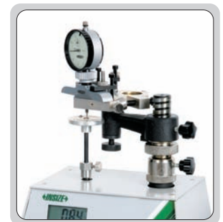
derinlik ölçüm aletlerinin kuvvetlerini ölçer
