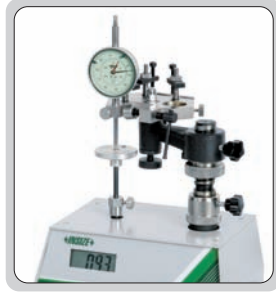
komparatörlerin ölçüm kuvveti kontrol uygulaması
