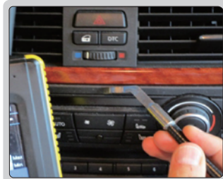
araç ön panelindeki boşlukların ölçülmesi
