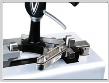
üç ayaklı iç çap mikrometreleri için sıfır ayarı ve kalibrasyon
