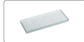
50mm okuma skalası (büyütme hassasiyeti kontrol edilir)
