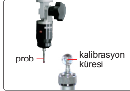
prob (opsiyonel), şunları içerir Ø1mm ve Ø2mm prob ucu, Ø20mm kalibrasyon topu, ölçüm hassasiyeti 5µm'dir
