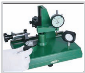
komparatör saatinin kuvvetini ölçme
