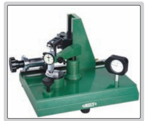
yanal kuvvetin salgı saatinin doğruluğu üzerindeki etkisini test etme (yarım yuvarlak blok master gereklidir)
