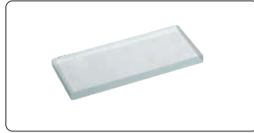
50mm okuma skalası (büyütme hassasiyeti kontrol edilir)
