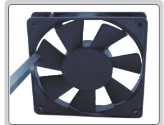
bıçak ile yan duvar arasındaki boşluğun ölçümü
