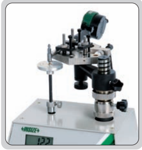
silindirik komparatörlerinin ölçüm gücünü kontrol eder
